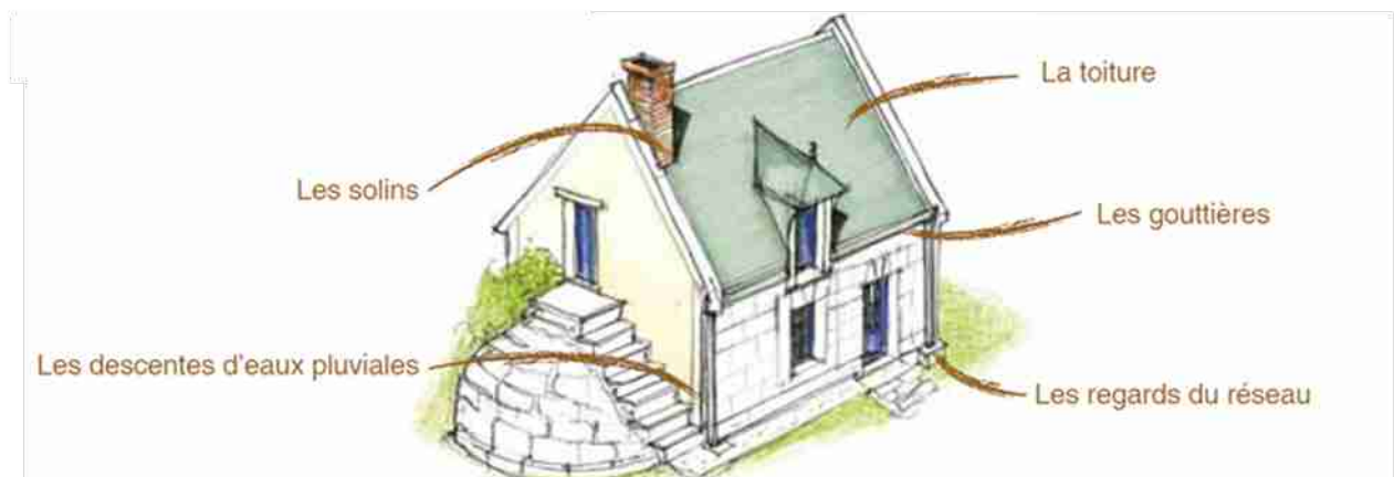
Figure 2-19 : Points de vigilance et d'entretien (Source : fiche n°5 Traiter l'humidité PNRLAT)
