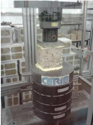
➔ Fabrication de prototypes sur presse à blocs en laboratoire
